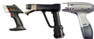
Heuresis Pb200i XRF Анализатор свинца - сравнение по размерам с PROTEC Instrument Corp. RMD LPA-1 и Thermo Scientific Niton™ XLp 300
