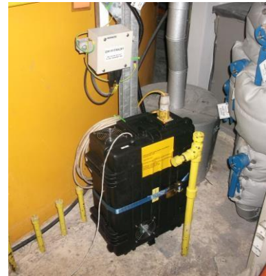
Рисунок 2: Временное устройство регистрации данных Teletest на рабочей площадке
